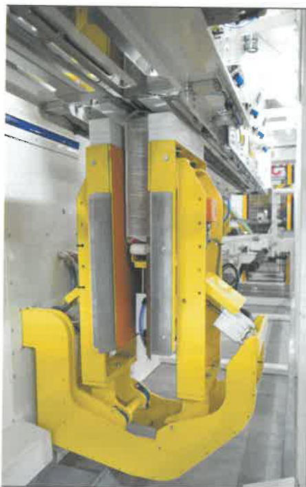
Des aléoles de formes permettent d'optimiser la désaération des sacs plastique et ainsi la palettisation qui suit.
