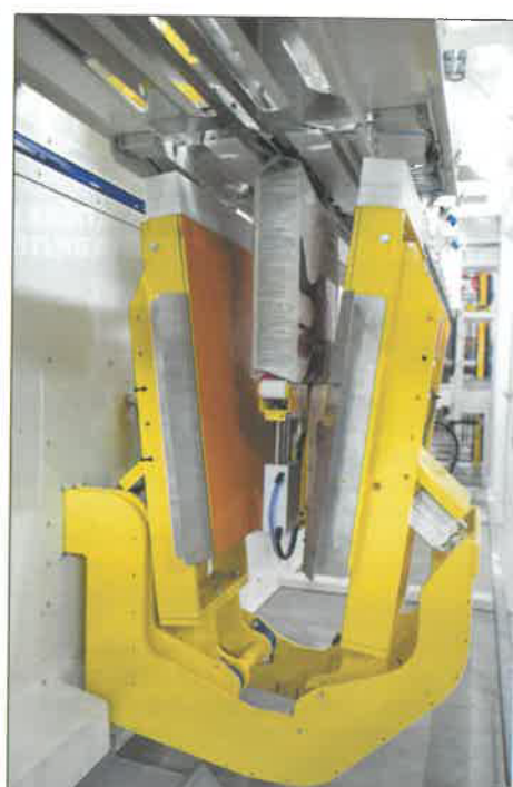
Des aléoles de formes permettent d'optimiser la désaération des sacs plastique et ainsi la palettisation qui suit.
